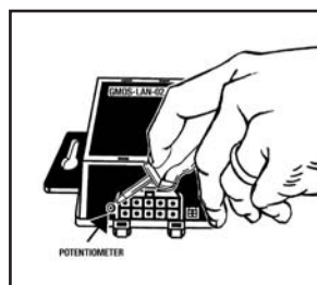
Potenciómetro situado en el lado de 16 pines de la interfaz
